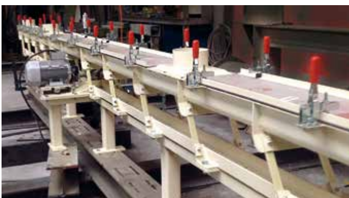
Transportador NFB con ballestas de fibra de vidrio
