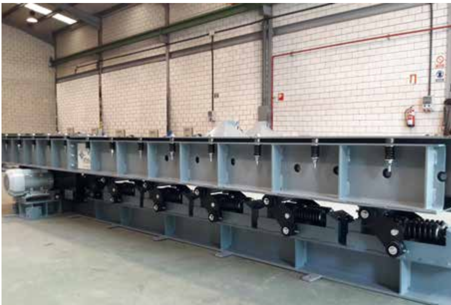
Transportador NFL con resortes helicoidales
