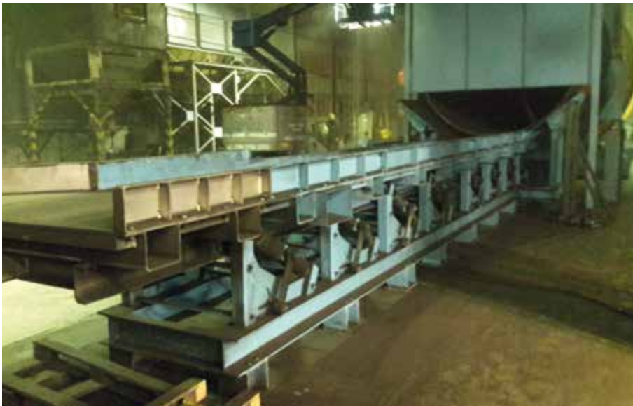
Transportador NFH con resortes helicoidales
