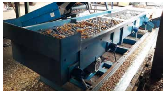
Transportador NFR con articulaciones elásticas
