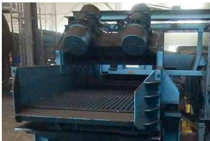
Démouleur vibrant Shakeout conveyor
