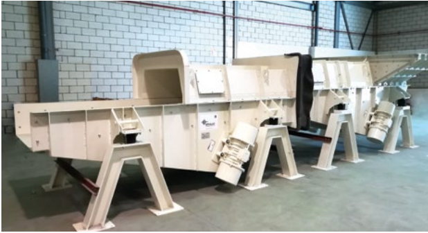
INCINERATOR SLAG CONVEYOR
